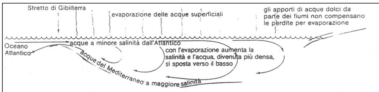
Fig. 4.2 - Caratteristiche generali del sistema di scambio idrico tra Atlantico e Mediterraneo
