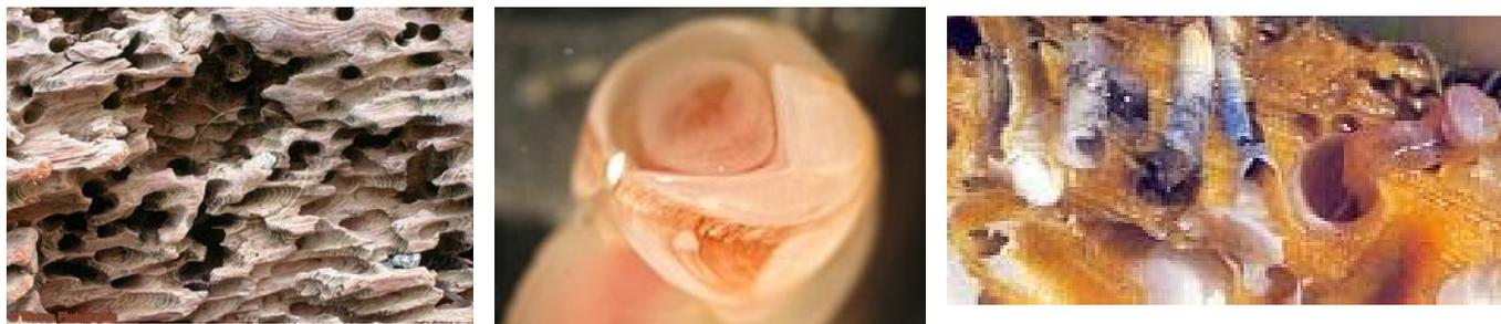
Fig. 6.30 – Gli effetti dell’insediamento delle teredini sul legno (a sinistra); le valve anteriori della teredine (al centro); i tubi calcarei nel legno (a destra).
