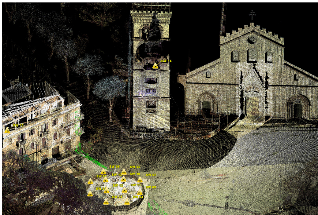
Fig. 10. Localizzazione dei punti stazione laser scanner in piazza Duomo sull'intera nuvola di punti.
